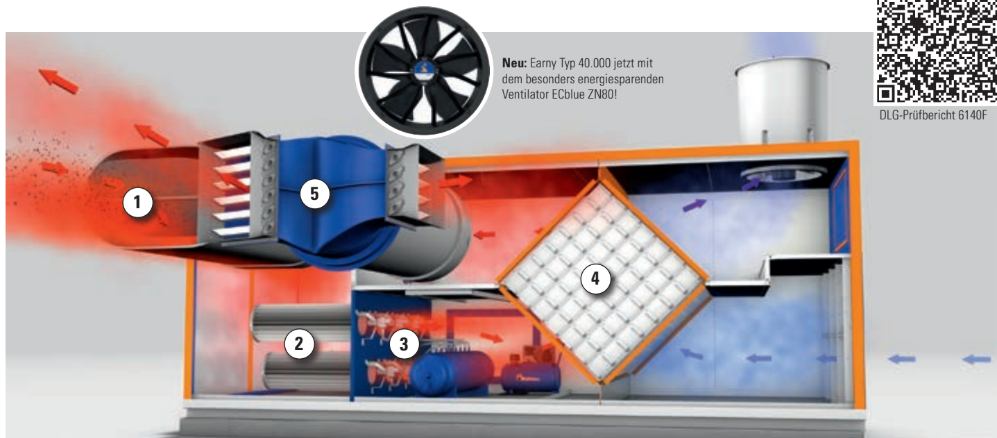
Az Earny hőcserélő vázlatos felépítése
